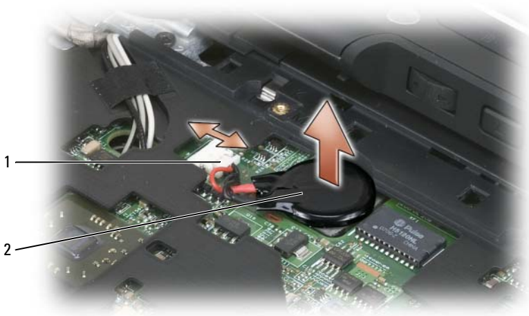
1 aansluiting voor knoopcelbatterij 2 knoopcelbatterij
